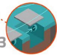
3 Sans **clapet anti-retour**, risque de remontée des eaux usées par le **réseau d'assainissement**
